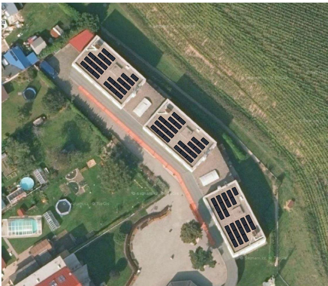
Obr. č. 3 Předpokládané rozmístění panelů na střechách
